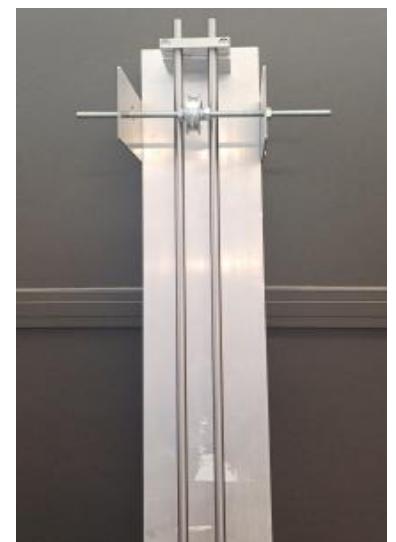
Figure 11: Montage de la poulie sur le banc de test
