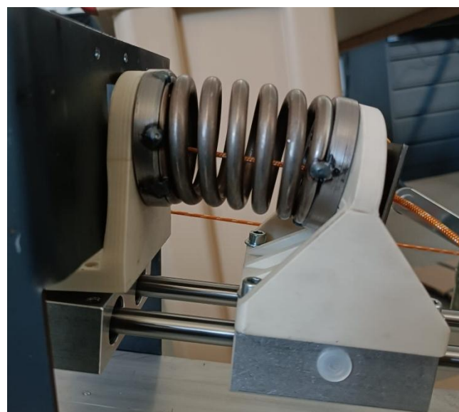
Figure 34: Ressort se comprimant de manière désaxée
